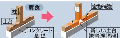
耐震金物を使用し、接合部をしっかり補強して床、壁、柱を一体化させます。
